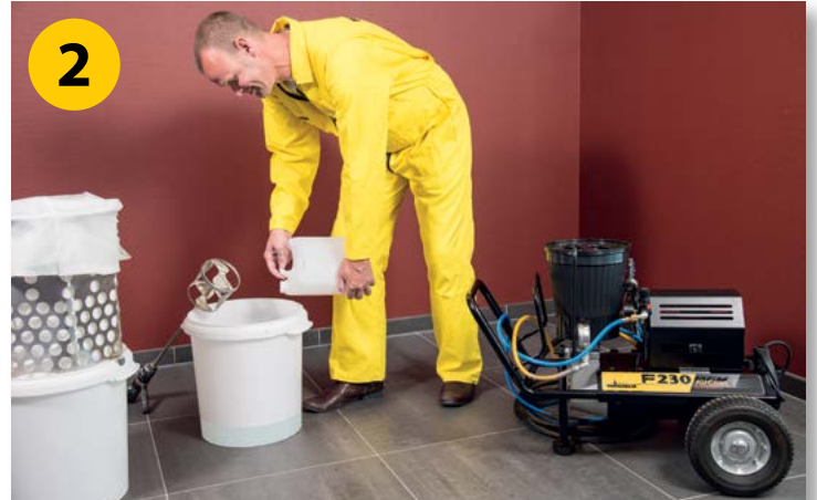
2 Aan het afvalwater wordt het Coaguleermiddel (vloeistof of poeder) toegevoegd.
