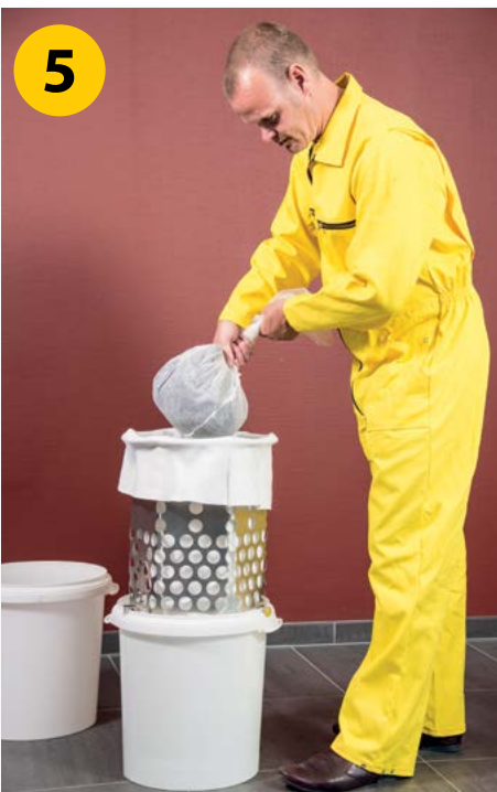
5 Zodra het afval water is doorgelopen, blijft het residu achter in de stofzak en kan deze er uitgenomen worden en als niet chemisch afval worden afgevoerd. Het water in de emmer is nu schoon!
