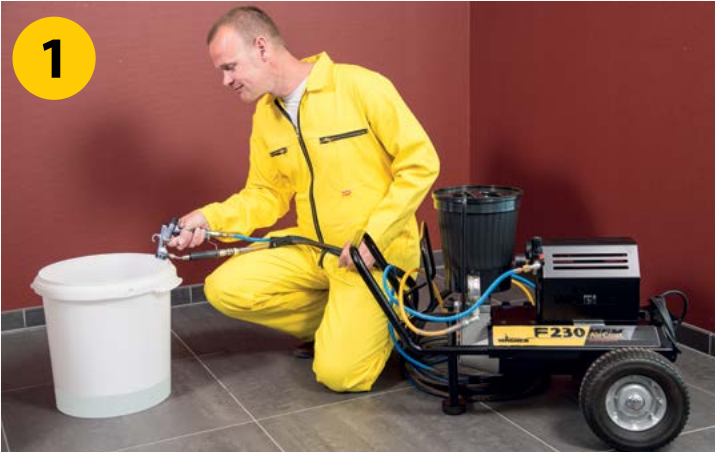
1 Na het spuiten wordt het spoelwater van de pomp in de emmer gespoten onder lage druk.
