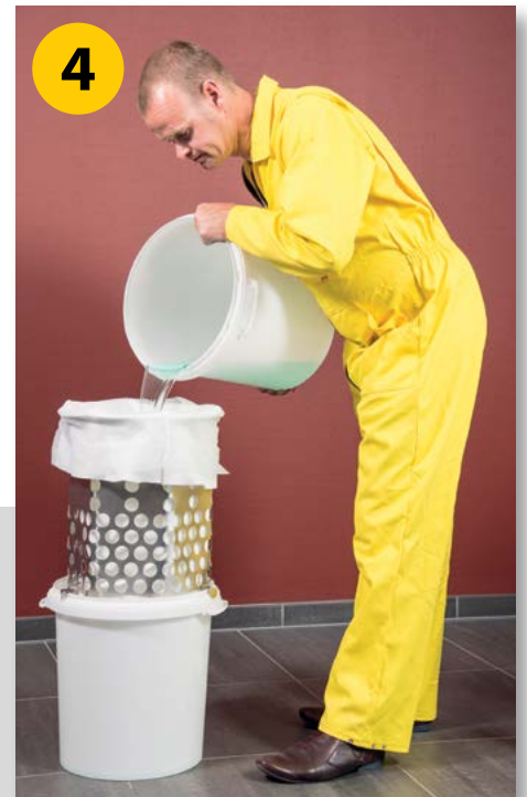
4 Het residu wordt in de afvalzak in het doorloopframe gegoten.
